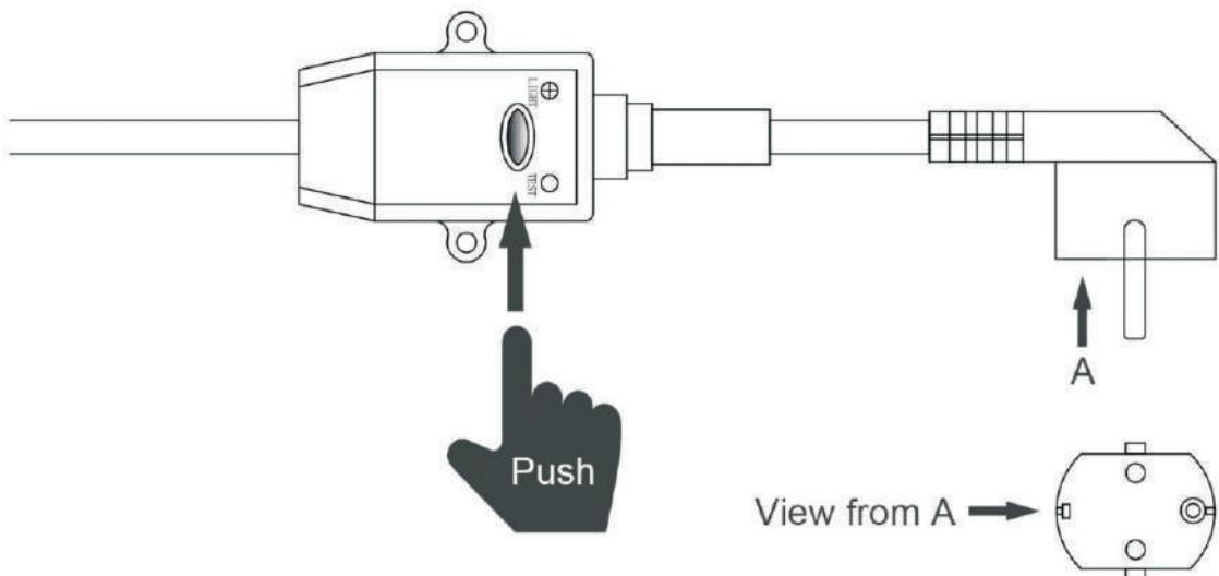
Der RCD-Stecker ist im Netzkabel enthalten, der einen elektrischen Schutz bietet.
